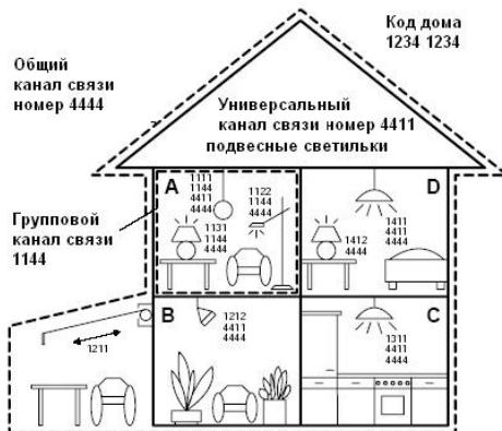
Все светильники дополнительно настроены на глобальный общий канал 4444, и имеют возможность дополнительного управления по общему каналу. Маркиз не настроен на общий канал, и следовательно, доступен для управления только по своему индивидуальному каналу.
